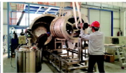
1.5T MRI磁体主线圈真空浸漆
