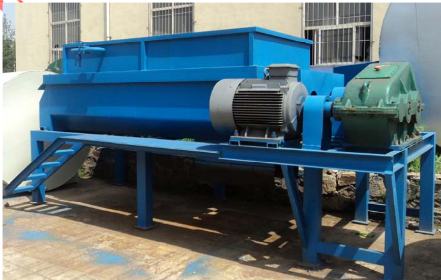
WCB 稳定土拌和站设备 搅拌装置
