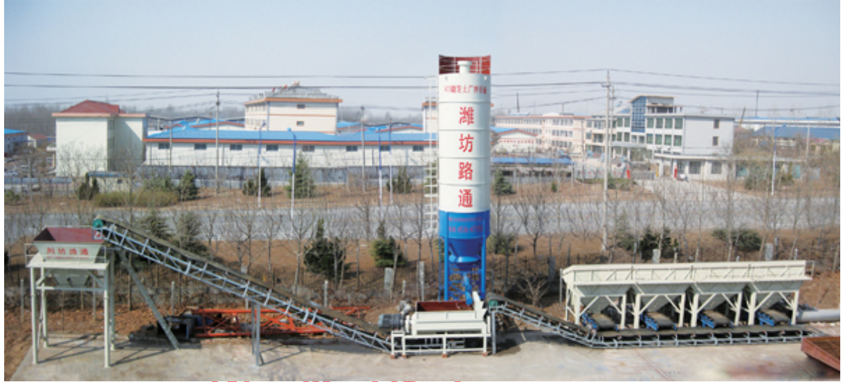
JWCB 稳定土拌和站设备总装示意图
