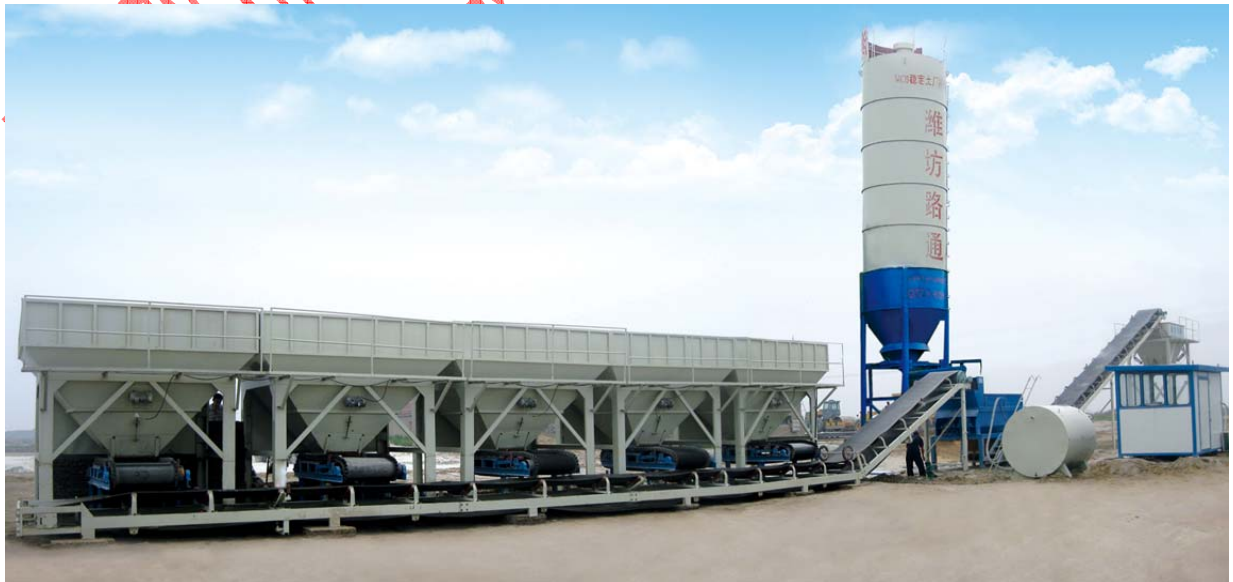
WCB 稳定土拌和站设备总装示意图
