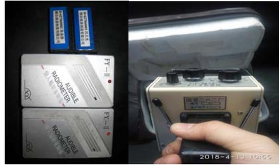
辐射巡检仪、个人剂量报警仪及个人剂量片
