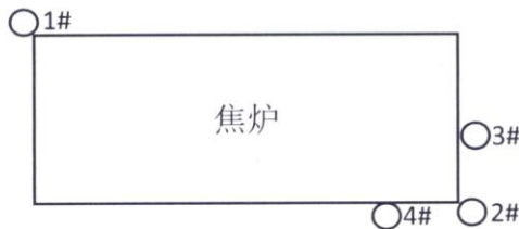
焦炉炉体无组织废气检测点位示意图
