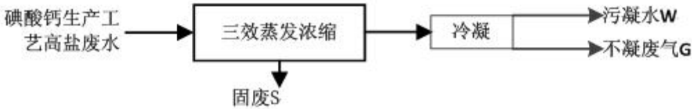
图 2.3-26 磷酸钙装置高盐废水处理工艺流程图
