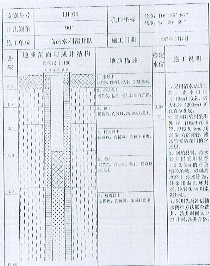
地下水质监测井施工图
