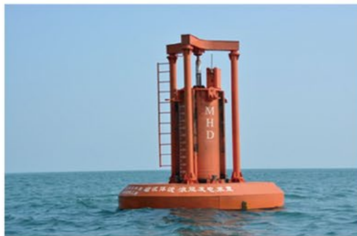
波浪能发电装置 Wave Energy Generator
